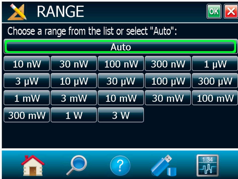
Figure 19. Fenêtre du menu de sélection d'échelle
