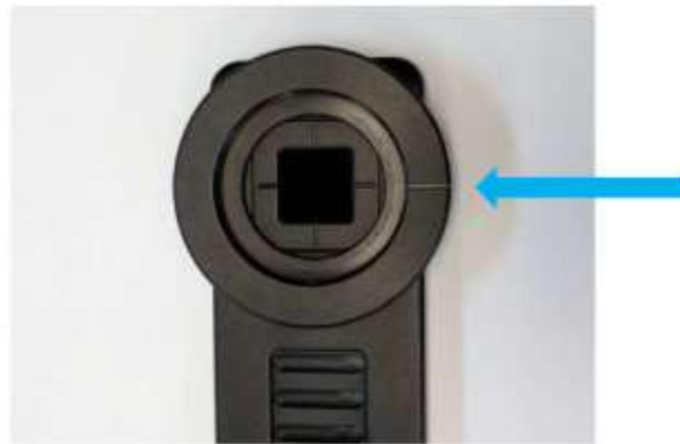
図 11 センサー取り付け時の調整。センサーの線とアダプターの線を合わせて下さい。
