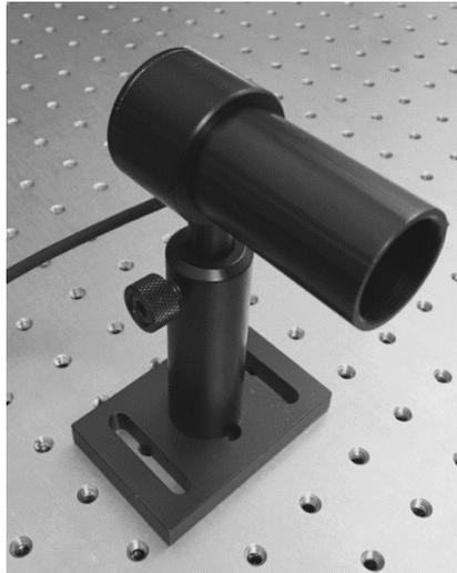
Le UM9B-BL-D0 offre une large bande dynamique de mesure de 300nW à 25mW. Il est compatible avec les moniteurs Maestro et U-LINK. Cette série de détecteur doit être utilisé avec un modulateur optique à 10 +/- 1Hz.
