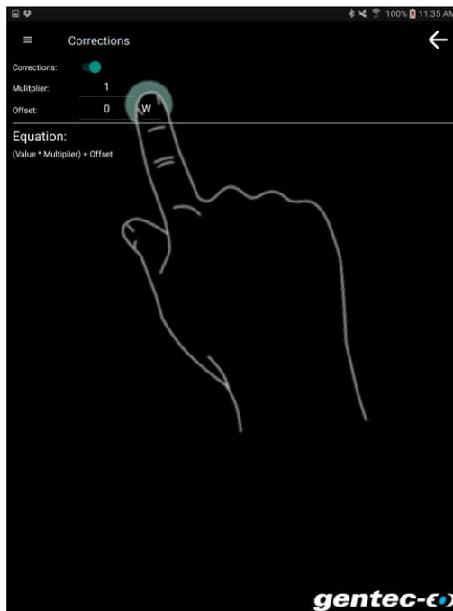
Figure 29. Réglage des corrections – tapez sur un chiffre pour faire le changement ou glissez le bouton de correction automatique pour l'activer
