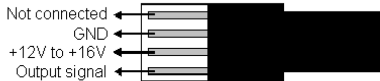
FIG. 1-4 Brochage de sortie du Connecteur Molex en version MT
