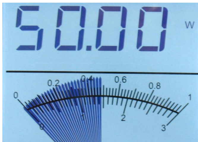
Illustration 1-5 Affichage de l'aiguille en mode graphique à barres
