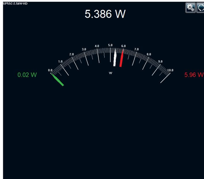
Fig. 3-21 Affichage NEEDLE (Aiguille) avec valeurs minimales et maximales
