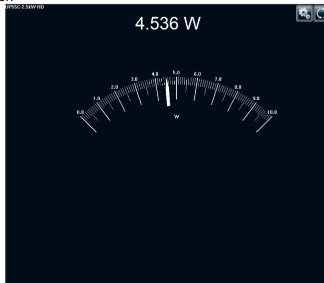
**Fig. 3-20 Affichage NEEDLE (Aiguille)**
