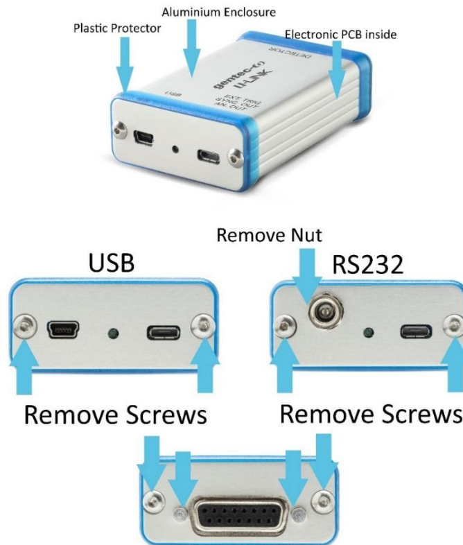
Figure 7. Ouverture de l'appareil U-LINK pour fins de recyclage en fin de vie utile
