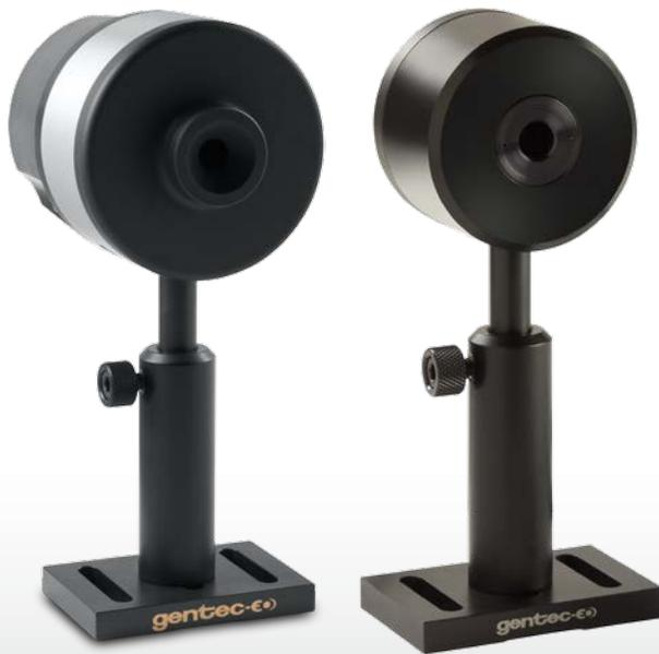
Notre gamme de radiomètres analogiques THz a été conçue pour être utilisée avec un oscilloscope ou un amplificateur à détection synchrone (LIA). Ils sont essentiellement composés d'un détecteur pyroélectrique doté d'un revêtement organique noir (BL) et connecté à un amplificateur de mode courant à faible bruit. La tension de sortie est maximisée à une fréquence de découpage de 5 Hz. La  $R_v$  de ces sondes est très élevée et peut être comprise entre 20 kV/W et 400 kV/W.
