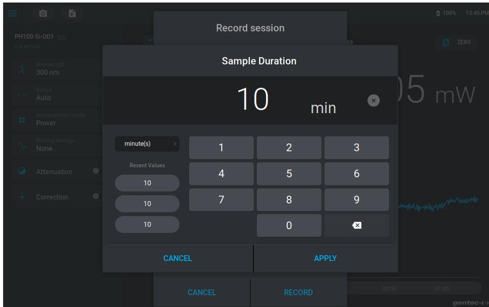
Lors de l'acquisition de données en mode énergie (joulemètre), la fréquence d'échantillonnage sera plutôt définie comme la fraction ( $1/x$  impulsions) des impulsions entrantes échantillonnées pour les calculs de statistiques et l'enregistrement de données. L'échantillonnage maximum sera alors de  $1/1$  (chaque impulsion comptera) jusqu'à une fraction de  $1/1\ 000\ 000$  (un millionième des impulsions sera considéré).
