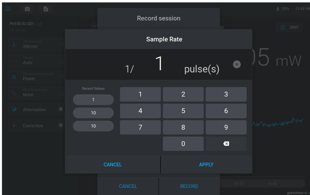
La durée d'échantillonnage en mode énergie se définit comme un nombre total d'impulsions plutôt qu'une mesure de temps fixe. Ainsi, dans l'exemple qui suit, l'acquisition se poursuivra tant que le MIRO ALTITUDE ne recevra pas 250 impulsions selon sa fréquence d'échantillonnage. Les valeurs acceptées se situent entre 1 impulsion jusqu'à 999 999 impulsions au total.
