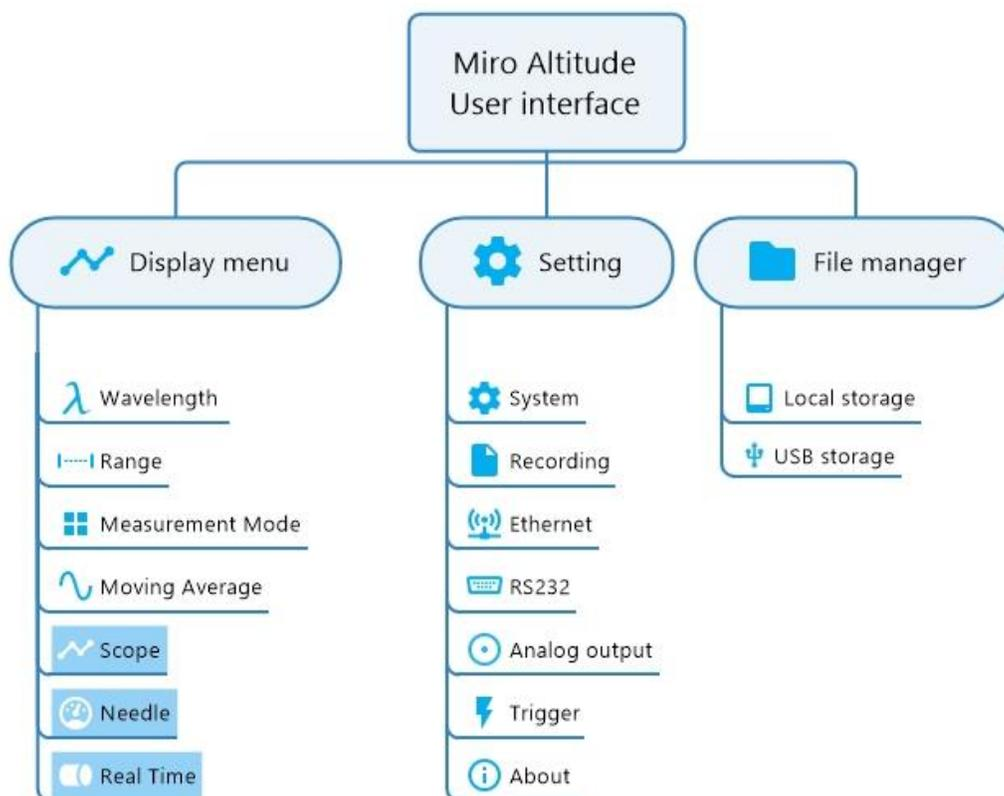
Un ensemble de boutons et d'icônes vous permet d'interagir avec l'interface utilisateur du MIRO ALTITUDE. Le tableau suivant décrit les différents boutons et icônes présents sur le MIRO ALTITUDE.
