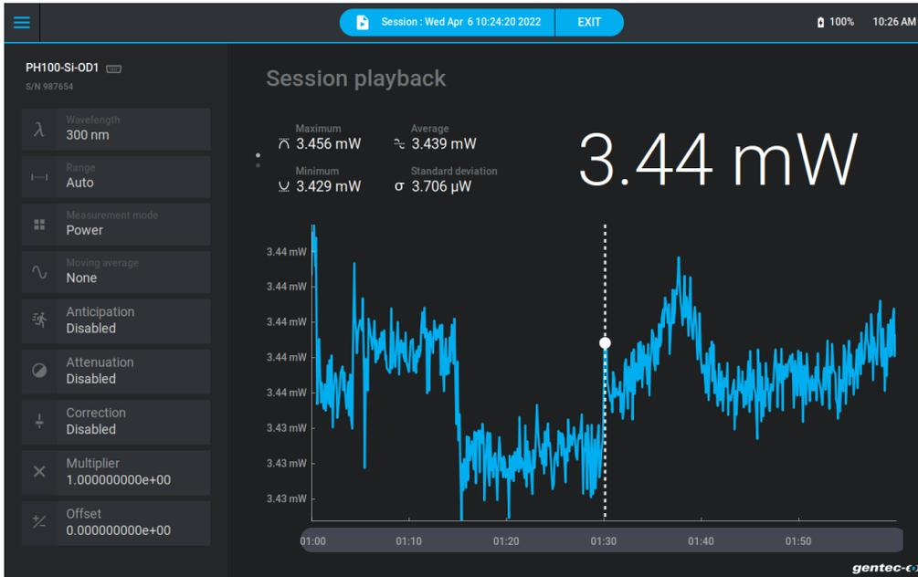
Lorsque le temps de l'acquisition est plus long que l'échelle de temps disponible, il est possible de glisser le doigt sur l'échelle de temps afin de faire défiler les données. Pour quitter la lecture d'une acquisition, il faut appuyer sur *Exit* dans le haut de l'écran, puis confirmer que l'on veut bien quitter la relecture.
