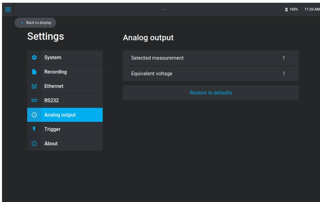
Pour sélectionner le signal d'entrée provenant du détecteur, appuyez sur *Selected measurement*. Le menu de l'image ci-dessous s'affichera. L'unité sera déterminée en fonction du détecteur connecté. Pour un wattmètre, l'unité sera W pour watt, et pour un joulemètre, l'unité sera J pour joule.
