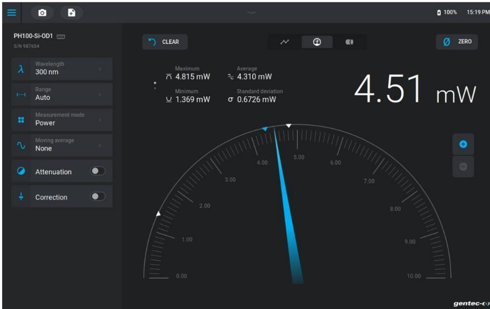
Il sera enfin possible d'effectuer un zoom à l'aide du bouton + à la droite de l'aiguille afin de peaufiner l'ajustement. Lorsque l'on fait un zoom avant, le cadran est gradué du minimum au maximum des valeurs mesurées depuis le dernier effacement. À noter qu'en mode zoom, les indicateurs des valeurs minimum, maximum et moyenne disparaîtront. Pour revenir en mode normal, simplement cliquer sur le bouton -.
