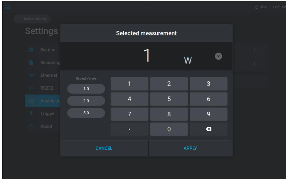
Pour sélectionner la tension de sortie, appuyez sur *Equivalent voltage*. Le menu suivant s'affiche. L'unité sera V pour volt. La valeur minimale pouvant être saisie est de 0,5 et la valeur maximale de 4,9.
