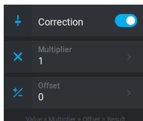
La valeur par défaut pour le multiplicateur est 1, et la valeur par défaut pour le décalage est 0. Il est essentiel de s'assurer que la valeur réelle mesurée est conforme aux limites de puissance et d'énergie de la tête de détecteur.
