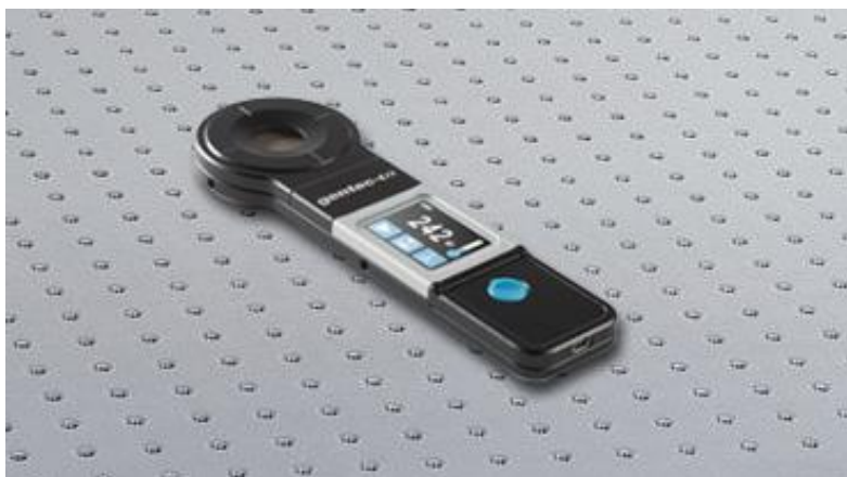
Figure 9. Configuration recommandée lors de la prise de mesure : installer l'appareil à plat sur la surface horizontale et l'illuminer d'en haut
