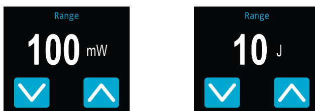
Figure 7. Boutons haut et bas pour régler l'échelle manuelle ou pour accéder de nouveau au réglage d'échelle par défaut « Auto »
