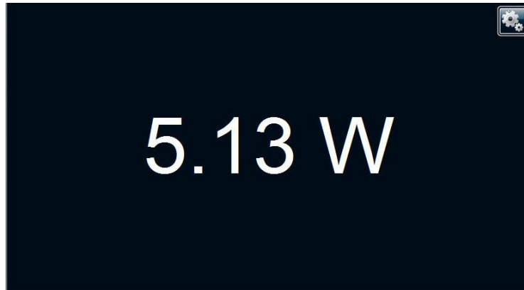
Figure 15. Affichage Real Time (numérique en temps réel) sans diagramme à barres
