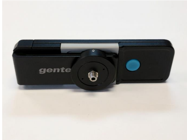
Figure 13. Manière optimale de ranger le PRONTO-Si avec l'adaptateur fileté
