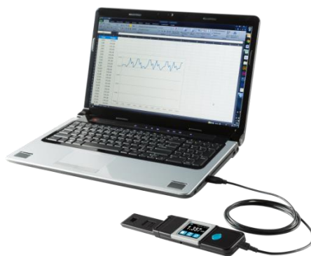
Figure 4. Transfert des mesures prises à l'aide d'un PRONTO-Si sur un ordinateur
