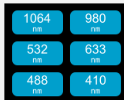
Figure 2. L'utilisateur peut personnaliser les six boutons de longueur d'onde
