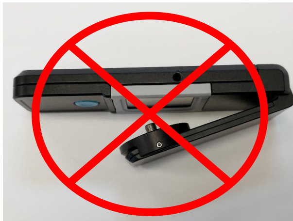
Figure 12. Ne pas fermer le PRONTO-Si lorsque l'adaptateur fileté y est fixé
