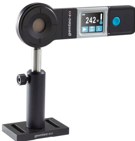
**Figure 8** - Configuration recommandée lors de la prise de mesure : installez l'appareil sur un support optique avant de le placer dans le faisceau laser.
